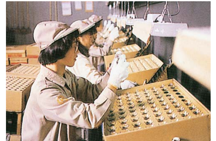
ネックチューブ管の検査作業
