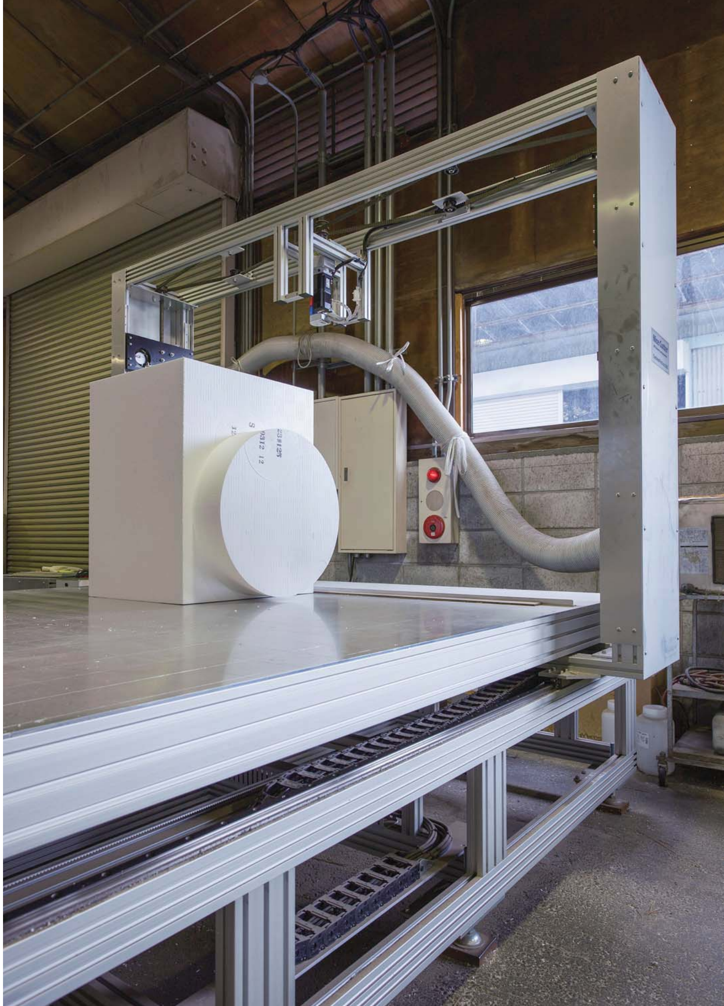
ナイスカッター（電鍍レンガ用砂型の元型となるスチロールの製作）
